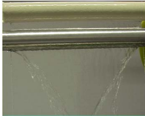
Fig. 9 : film liquide très stable entre les deux tubes et sans ondulations à la surface libre.
